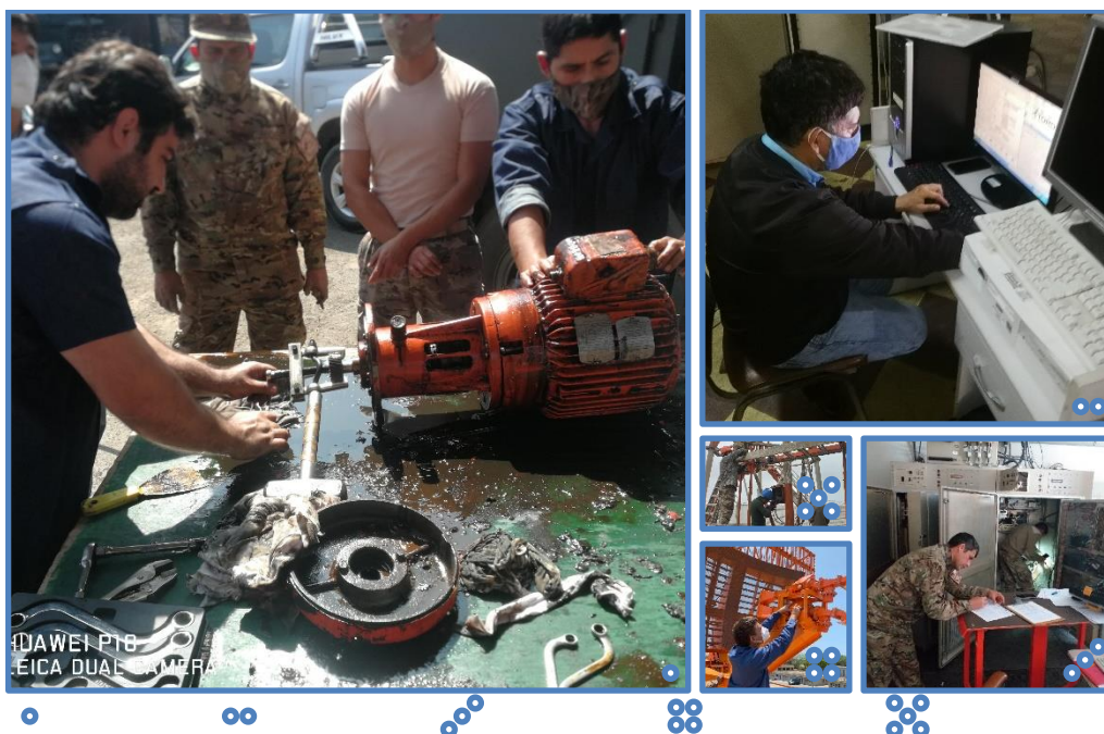
Figura6.- Trabajo de mantenimiento preventivo en línea, del sistema de rotación de antena de los sensores de alarma temprana.
