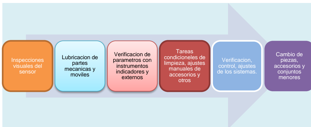
Figura 5: Tareas desarrolladas en el mantenimiento preventivo de los sensores de alarma temprana en el GRUDA
